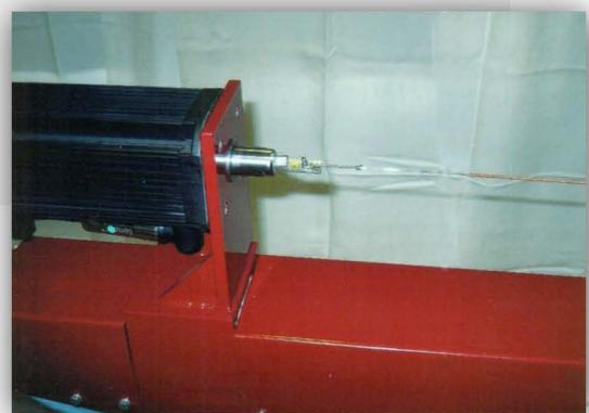
Робота рухомої намотувальної головки і натяг керна струни проходить пневматично з допомогою встановлення тиску. Пневматичний натяг струн постійно забезпечує при цьому постійну напругу при натягуванні. Якщо раптово на керні струни виявляється дефект, не виникає жодної загрози нещасного випадку так, як рухомий суппорт поступово зупиняється.
